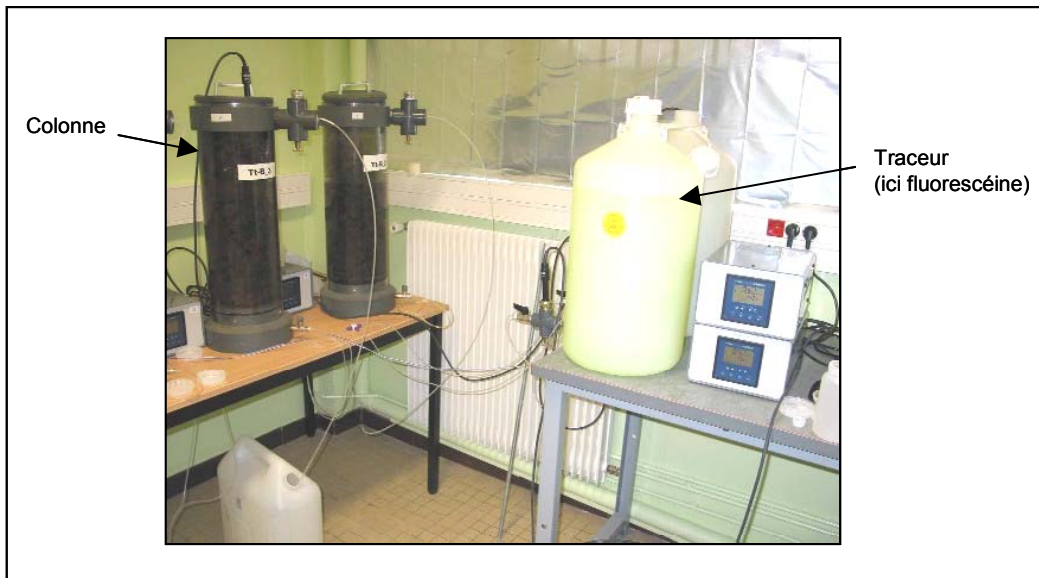
Figure 2.15. Essais de traçage dans les colonnes de lessivage
