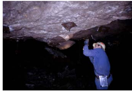
Figure 2.3. Prélèvement in situ de blocs du toit de la couche brune sur le futur site pilote (stot de Tressange)
