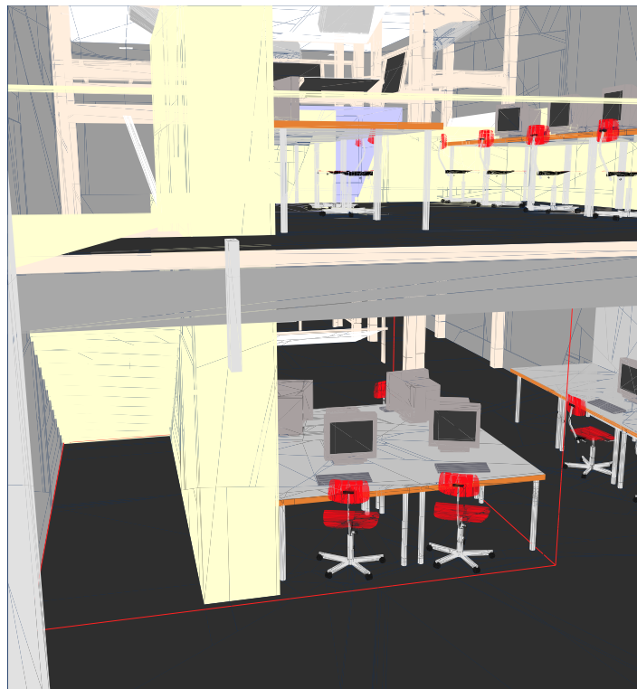
FIG. 1.8: Exemple d'occlusion triviale : les objets situés au rez-de-chaussée ne peuvent interagir directement avec ceux situés à l'étage. L'utilisation d'une hiérarchie de groupes permet de détecter de tels cas au début du processus de raffinement des liens, permettant ainsi un gain de temps substantiel.
