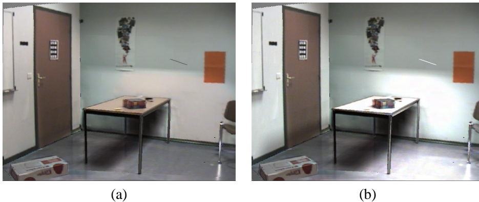
FIG. A.2: (a) Insertion d'une lampe virtuelle, sans utiliser un affichage multi-passes. (b) Utilisation d'un affichage multi-passes (5 passes en 0.3 secondes).
