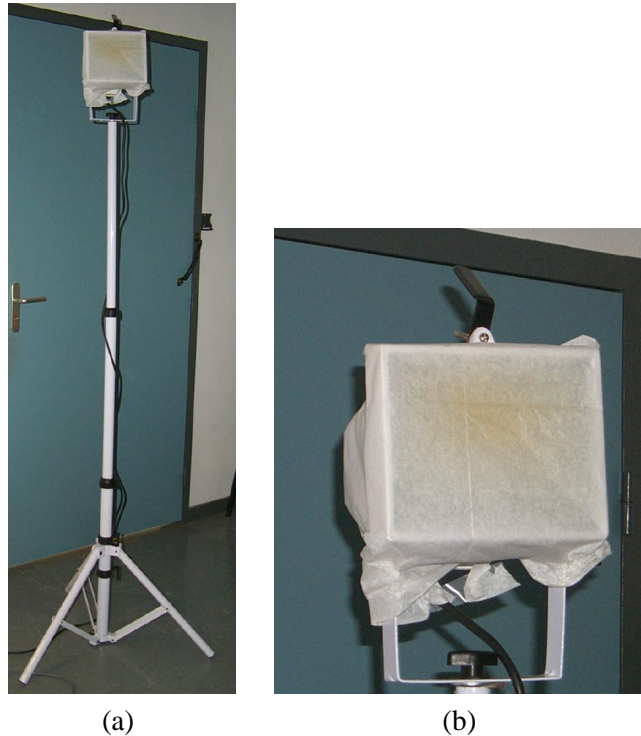
FIG. 3.12: (a) Lampe utilisée pour éclairer les scènes lors de nos tests. (b) La lampe est recouverte d'un papier de soie, permettant de se rapprocher du caractère diffus.
