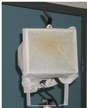
FIG. 5.3: Lampe utilisée pour éclairer les scènes lors de nos tests. Elle est recouverte d'un papier de soie, permettant de se rapprocher du caractère d'émission diffuse.
