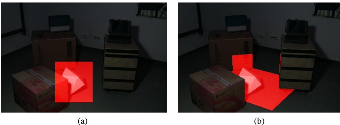
FIG. 5.18: Un objet virtuel est inséré dans la scène. (a) Les pixels localisés en gris clair sont ceux sur lesquels il y a des changements visuels potentiels à cause de la projection de l'objet virtuel sur l'écran. (b) Les pixels localisés en gris clair sont ceux pour lesquels il y a des changements de visibilité potentiels, dus aux ombres.
