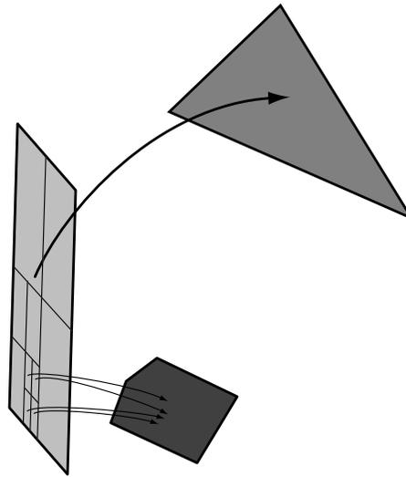
FIG. 2.5 – Radiosité hiérarchique : les interactions entre les objets.
