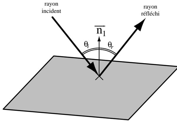
FIG. 2.1 – Loi de réflexion de Descartes : surfaces spéculaires.
