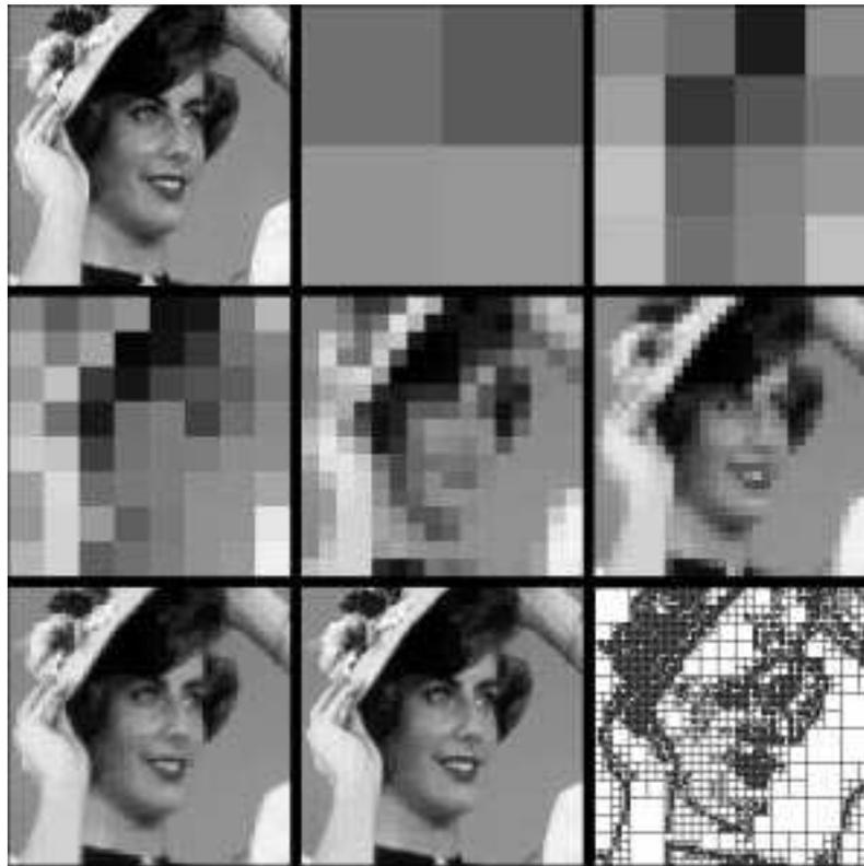
FIG. 34 - Partitionnement en quadrees de l'image "femme". De la gauche vers la droite et de haut en bas : image originale  $\Gamma$  4 carrés  $\Gamma$  16 carrés  $\Gamma$  64 carrés  $\Gamma$  244 carrés  $\Gamma$  874 carrés  $\Gamma$  3037 carrés  $\Gamma$  9823 carrés  $\Gamma$  représentation des carrés.
