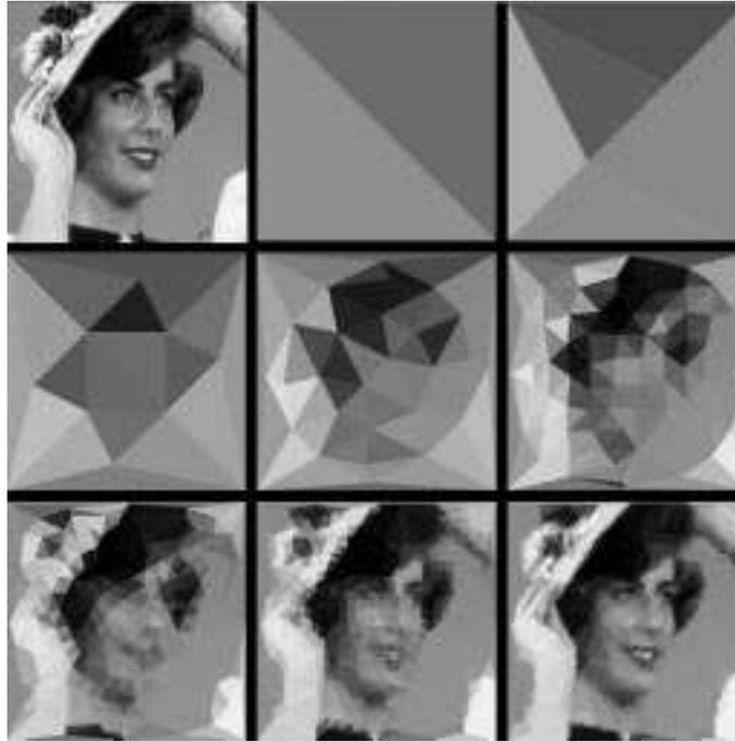
(a) Division. De la gauche vers la droite et de haut en bas : image originale, 5 triangles, 13 triangles, 62 triangles, 155 triangles, 365 triangles, 822 triangles, 1703 triangles, 3821 triangles.
