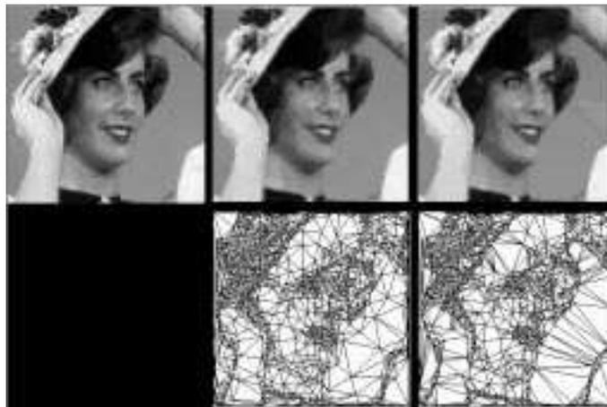
(b) Résultat. Image originale à gauche, résultat de la division (5530 triangles) au centre et le graphe correspondant au-dessous, résultat de la fusion (4215 triangles) à droite et le graphe correspondant au-dessous.
