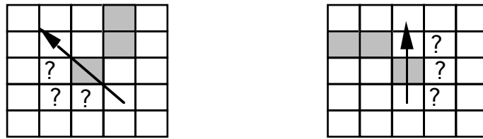
Figure 20 : Trois pixels sont examinés, en fonction de la direction du gradient sur le dernier pixel.
