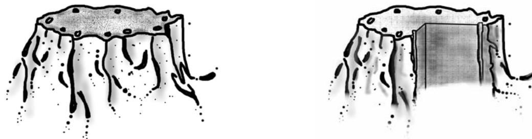
figure 5-28 Modèle proposé du jet Diesel pour  $P_i \approx 50$  MPa.
