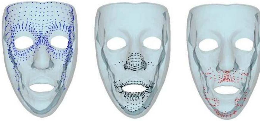
FIG. 10.8 – Les différents ensembles de noeuds internes sur le modèle d'un patient. De gauche à droite, les noeuds bloqués, les noeuds libres et les noeuds solidaires des segments d'ostéotomie. Noter les noeuds correspondant au décollement per-opératoire, autour des traits d'ostéotomie et sur la face antérieure de la mandibule (en cas de génioplastie).
