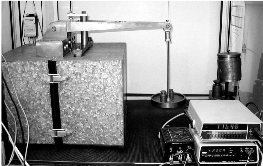
Photographie II.3. Dispositif de mesure des variations de hauteur et de rayon de l'échantillon.
