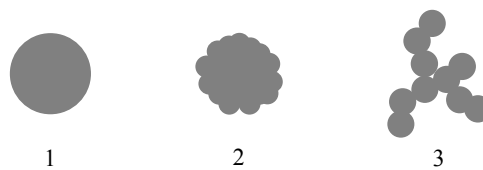
Figure III-12. Influence de la structuration des particules sur leur circularité
