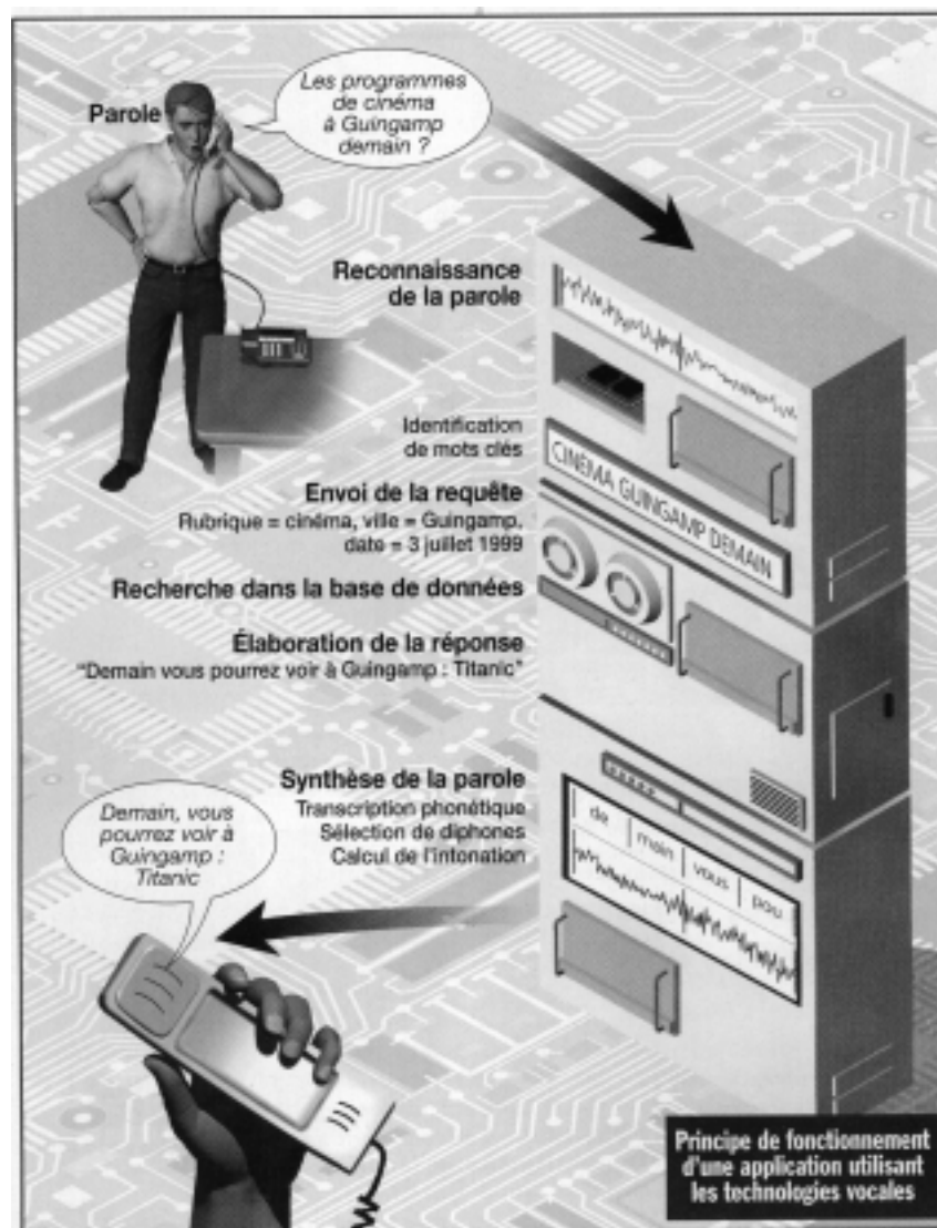
Figure 21 : Principe de fonctionnement d'une application utilisant des technologies vocales
