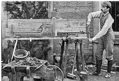
Machine à déformer des lits d'argile de J. Hall (1815)
