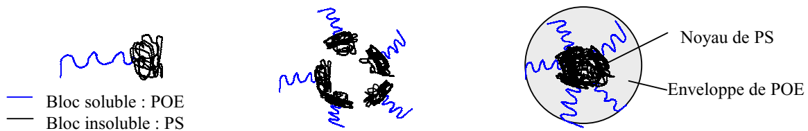
Figure 33 : Représentation schématique de l'organisation microscopique du copolymère PS-b-POE dans le mélange CO 2 /éthanol de composition massique (91/9) SC.
