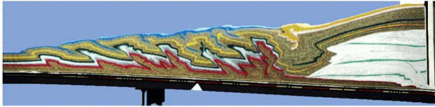
FIG. 7.4 – Modèle analogique de boîte à sable utilisé par Kukowski *et al.* lors de l'étude du Western Mediterranean Ridge [86].
