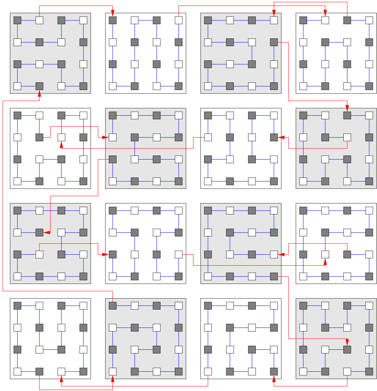
FIG. 4.13 – Un circuit hamiltonien dans OTIS - Mesh \equiv (H(4, 4, 4) \otimes H(4, 4, 4)) [M(4, 4)] .
