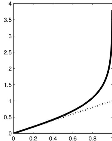
FIG. 8.6: *Fonction arc-tangente hyperbolique, assimilable à une droite de pente 1 (en pointillé) pour des abscisses entre 0 et 0,5 ; puis se comportant de façon exponentielle jusqu'à atteindre l'infini pour une abscisse de 1*
