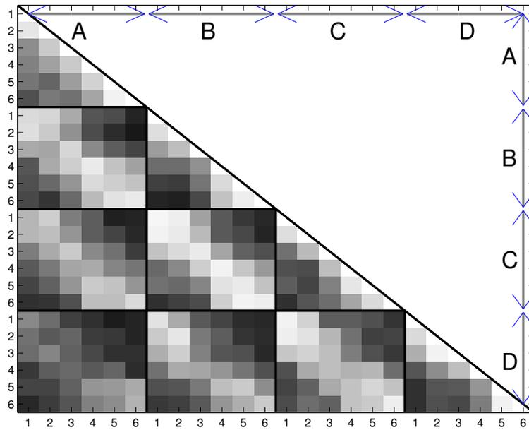
FIG. 10.2: Matrice de dissemblance de l'Exp. VIII. Chaque lettre représente une  $F_0$  utilisée : A)  $si_2$ , B)  $fa_3$ , C)  $do\#_3$  et D)  $fa_4$ . Chaque chiffre représente une valeur d'étalement spectral dans l'ordre : 4, 4,5, 5, 5,5, 6 et 6,5 ERBrate.
