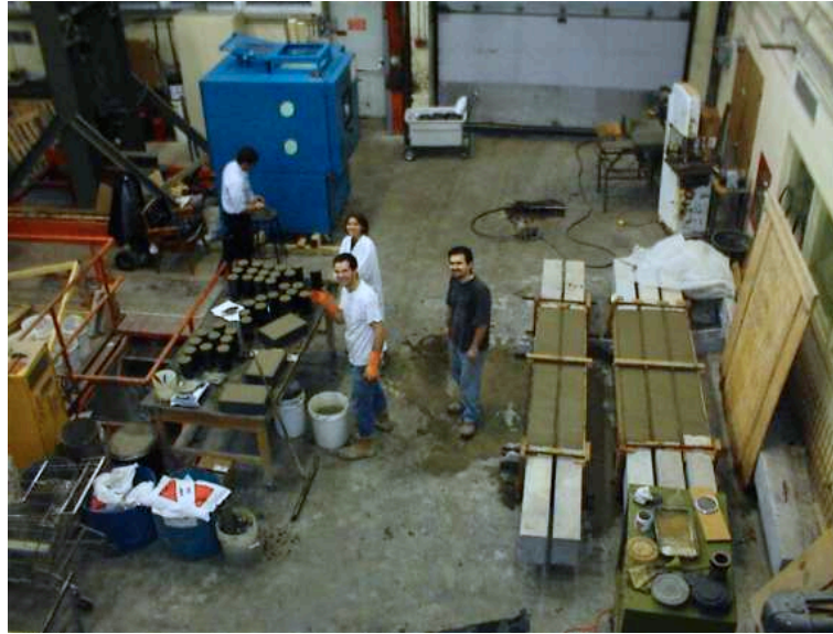
FIG. 3.3 – Coffrage, mise en place et confection des éprouvettes d’essais pour les bétons ordinaires et autoplaçants
