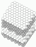
Une multicouche Au(111)/Ni(111) avec une désorientation de 30 degrés.
