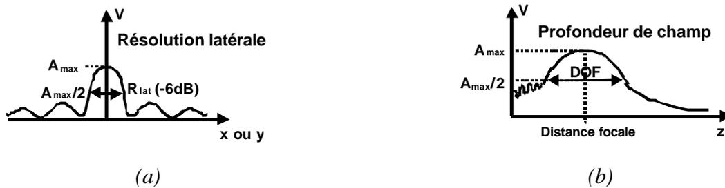
*Figure I.21 : Mesure du champ rayonné : (a) résolution radiale et (b) profondeur de champ.*
