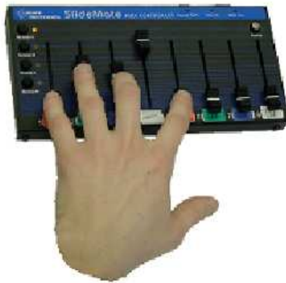
FIGURE 4.9 – Boîtier midi utilisé pour contrôler la couleur de l'outil de dessin de SVALABARD.
