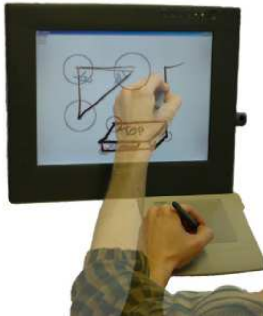
FIGURE 4.14 – Interaction avec deux tablettes graphiques. La tablette écran est utilisée pour dessiner, alors que la seconde tablette permet de tracer de simples annotations avec le même stylet. Le changement d’outil est naturel, sans avoir à changer de stylet.
