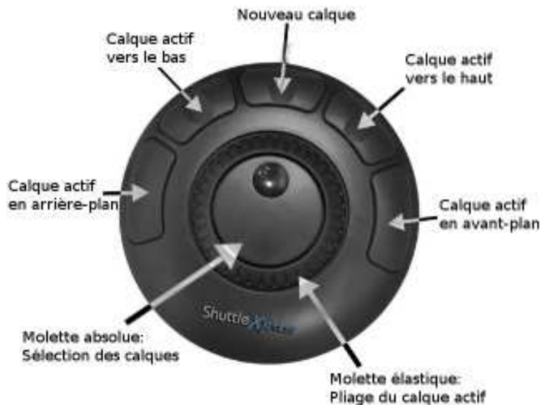
FIGURE 4.10 – Shuttle (périphérique réunissant molettes et boutons) utilisé pour la création et sélection des calques de la feuille de dessin de SVALABARD.
