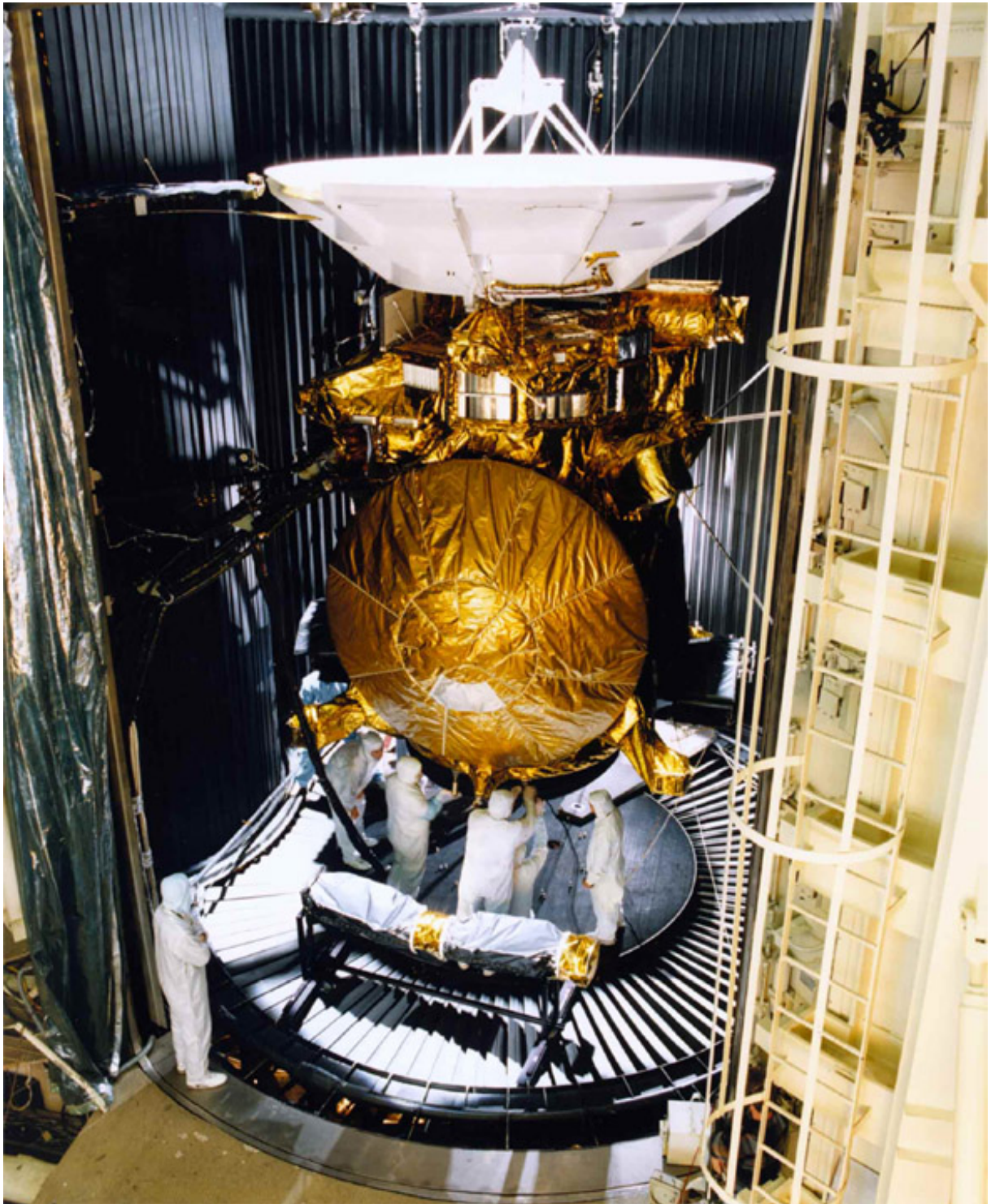
FIG. 3.1 – La sonde Cassini–Huygens avant le lancement. On peut distinguer, en haut, l’antenne de télémesure en blanc, et la sonde Huygens qui masque une grande partie du corps de la sonde.
