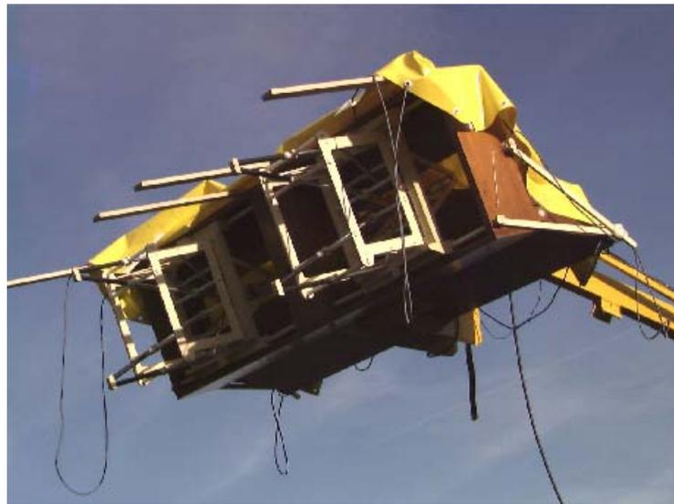
**Figure 1-9 :** Antennes ULB de type CISEAUX avec positionneur
