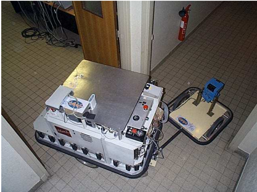
FIG. 4.7 – Le robot Hilare 2 et sa remorque lors du passage de la porte dans la zone d'acquisition des données (voir figure 4.5)
