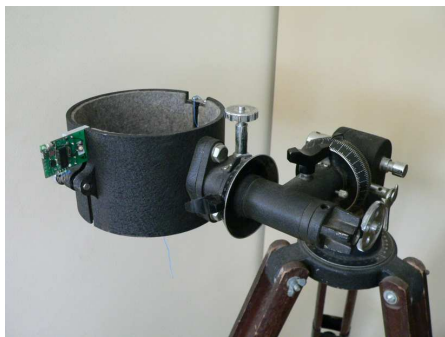
FIG. 9.1: Dispositif expérimental pour le calibrage des angles (roulis, tangage)
