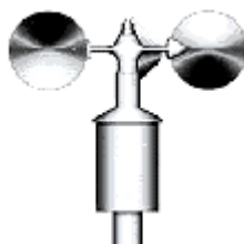
Figure 2-21 - Anémomètre à trois coupelles à 120°
