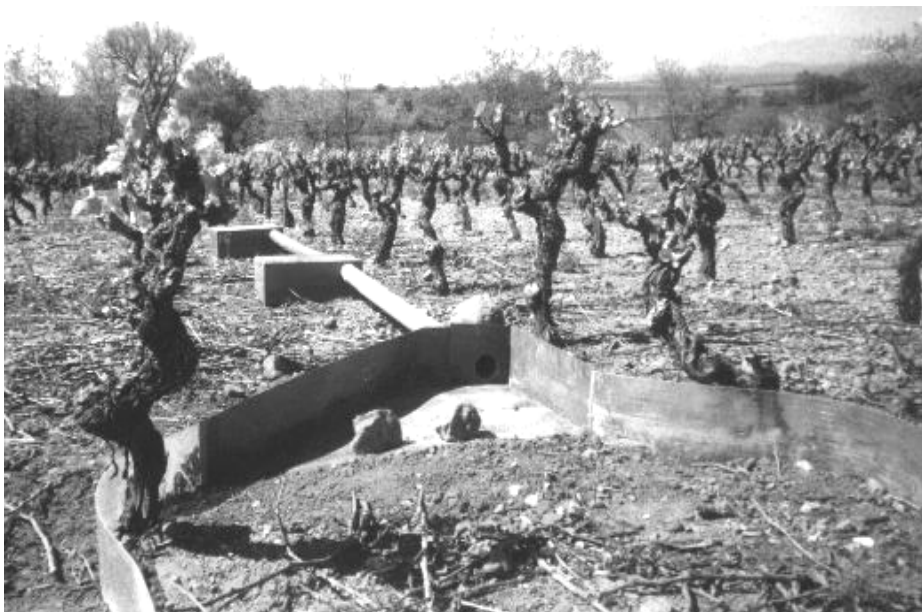
Figure 12 : Système de prélèvement ponctuel des eaux de ruissellement à la surface de l'inter-rang d'une parcelle viticole (parcelle sur sol acide). Photo A. Deveze et R. Gilbin.
