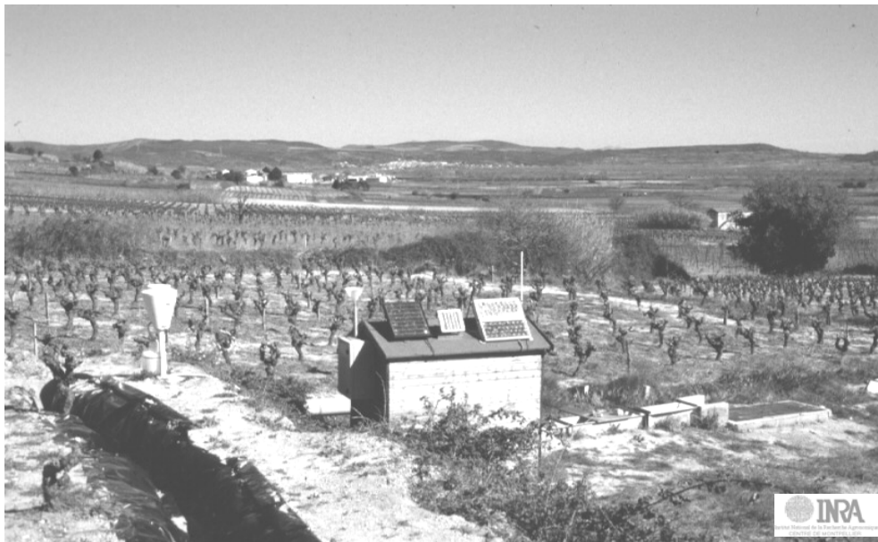
À gauche : le canal collecteur imperméabilisé, le pluviomètre Dans l'abri : préleveurs automatiques et système de liaison radio À droite : canal venturi avec nilomètre et partiteurs
