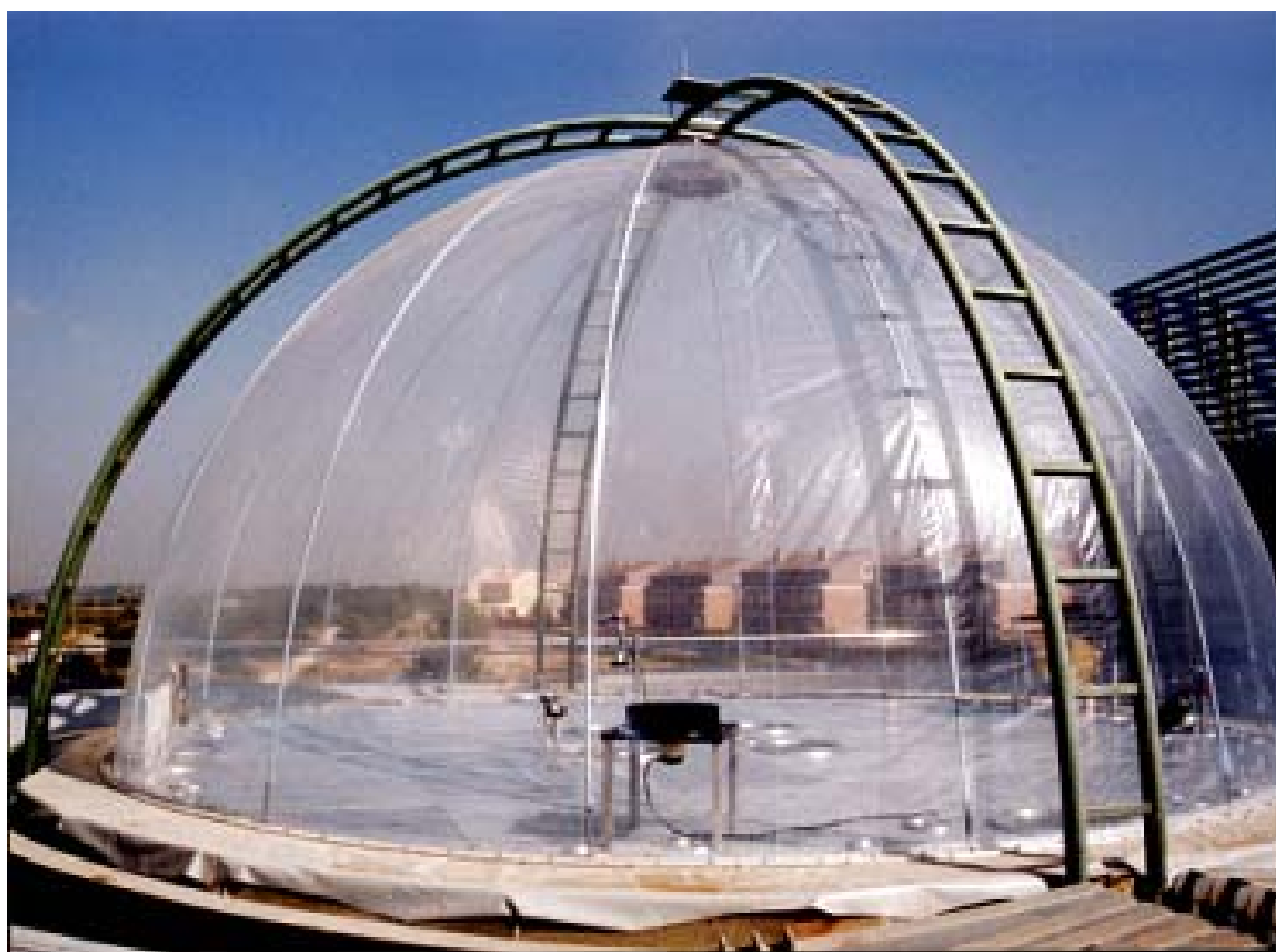
Figure 13 : Chambre de simulation atmosphérique d'EUPHORE.
