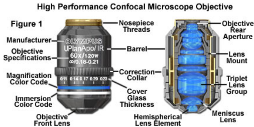
Figure 52 : Description de l'objectif utilisé
