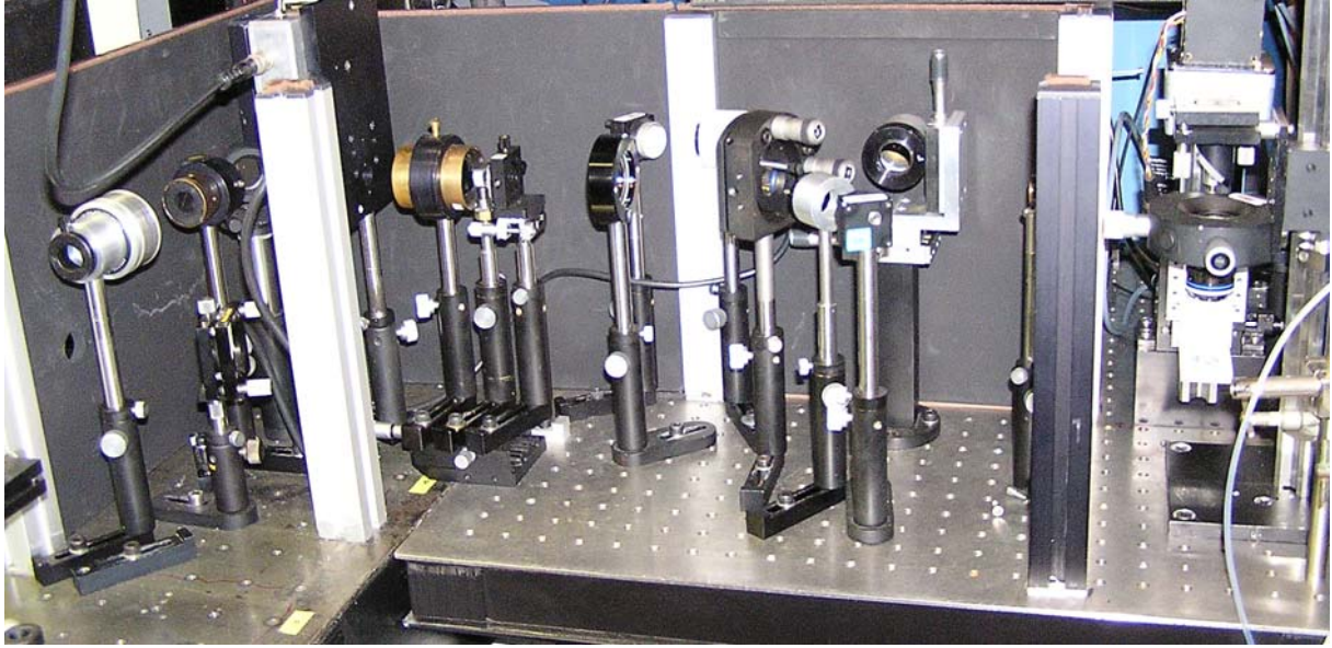
Figure 59 : Photo du dispositif optique confocal
