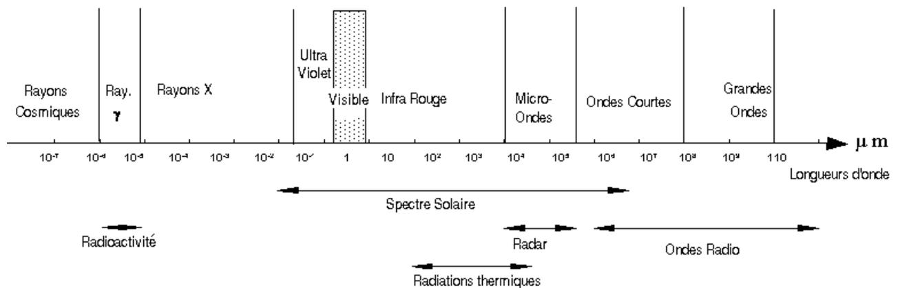
FIG. 1.3 – Spectre électromagnétique
