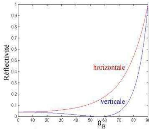
FIG. 1.4 – Réflectivité d'une onde électromagnétique à l'interface entre deux milieux d'indice  $n_1=1$  (air) et  $n_2=1.5$ , selon le modèle de Fresnel.  $\theta_B$  est l'angle de Brewster.
