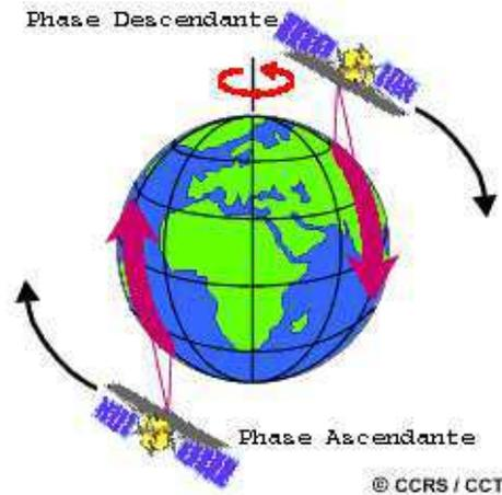
FIG. 1.6 – Phases orbitales d'un satellite en orbite polaire.
