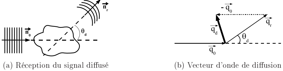
FIG. 3.3 – Principe de mesure de la diffusion du son
