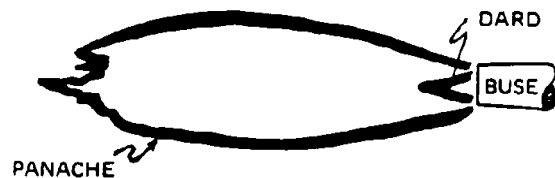
Figure II- 3 : Allure d'une flamme riche en comburant. La flamme oxydante a aussi un dard et un panache. Elle est sifflante et le panache est violet de contour irrégulier.
