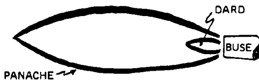
Figure II- 1 : Allure d'une flamme dite normale c'est-à-dire qui correspond à une combustion complète.
