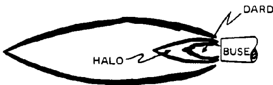
Figure II- 2 : Allure d'une flamme pauvre en comburant Un excès d'oxygène donne une flamme carburante dont le dard est entouré d'un halo blanc.
