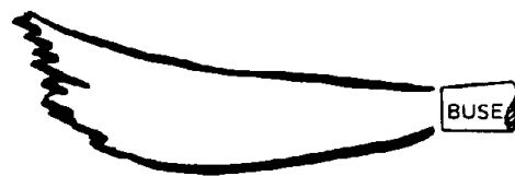
Figure II- 4 :Allure de la flamme lors de la combustion sans apport d'oxygène. La combustion s'effectuant avec l'air ambiant donne une longue flamme jaune et des émissions de carbone solide.
