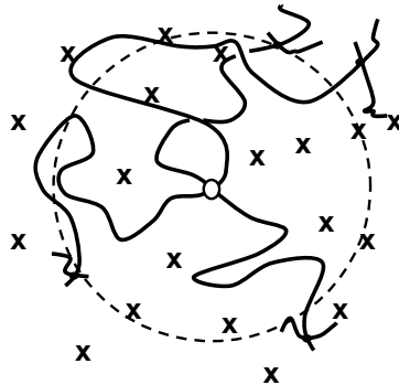
Figure A.46 : Modèle de jonctions contraintes - (o) jonction courante ;(x) jonctions voisines
