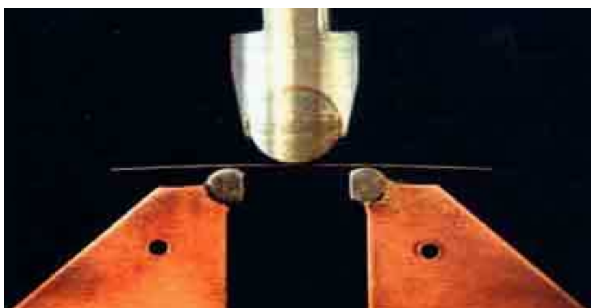
Figure II-27 : Test de flexion trois points pour la mesure de modules d'Young
