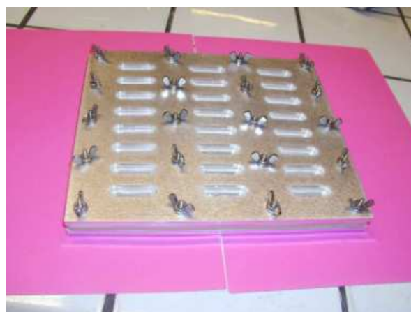
Figure II-22 : Moule en silicone et plaques d'aluminium utilisés pour la fabrication des échantillons de flexion 3 points
