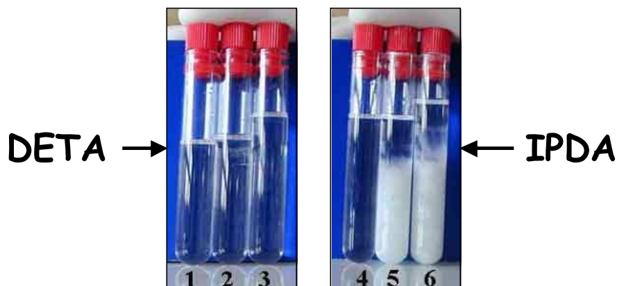
Figure III-1 : Comparaison d'amines pures et modifiées. DETA et IPDA pures (tube 1 et 4 respectivement) et modifiées par l'aluminium et le titane (tubes 2 et 3 pour la DETA, 5 et 6 pour l'IPDA)
