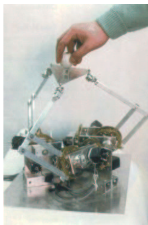
FIG. 1.2 – Le HapticMaster , structure parallèle à 3 ddl actifs
