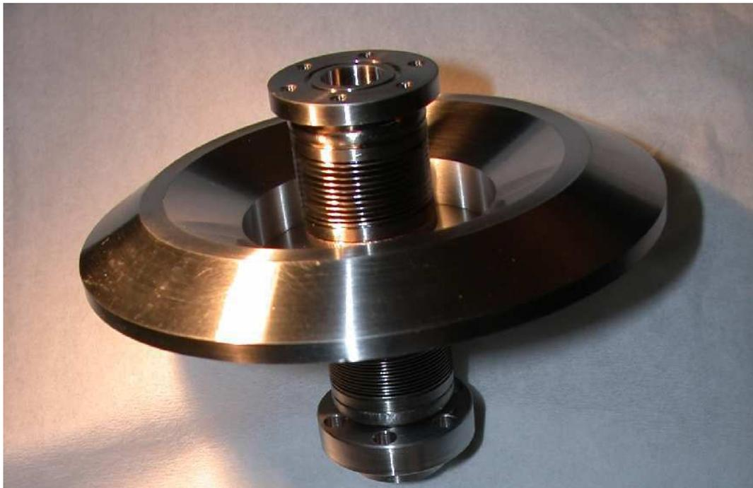
FIG. 2.4 – La "pièce à soufflet" assure le contact entre le montage ultra-vide de la source d'atomes lents et le cœur du cryostat. Les soufflets permettent d'absorber les contractions thermiques et facilitent la connexion des deux parties du montage.
