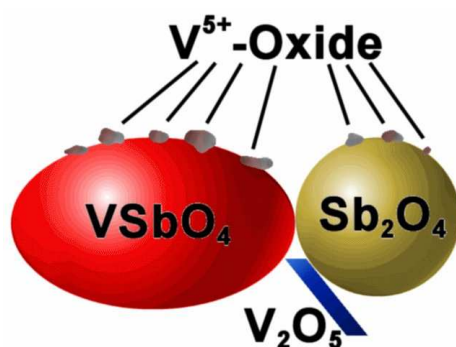
Fig. 11. Vision schématique de la structure des catalyseurs V-Sb-O préparés par la méthode « slurry ».
