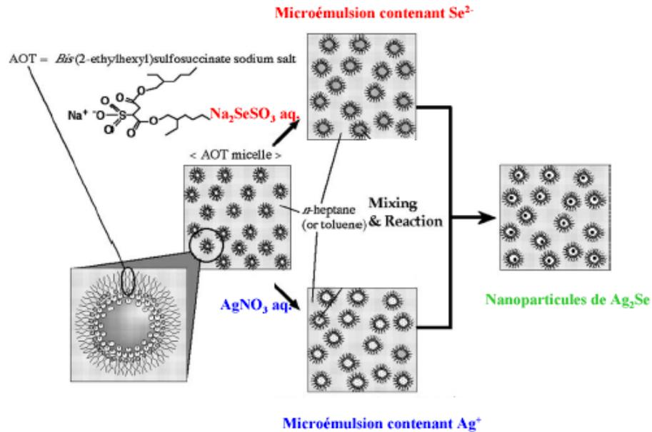
**Figure 2.5.** Schéma illustrant la méthode de double microémulsion pour obtenir des nanoparticules d'Ag<sub>2</sub>Se.
