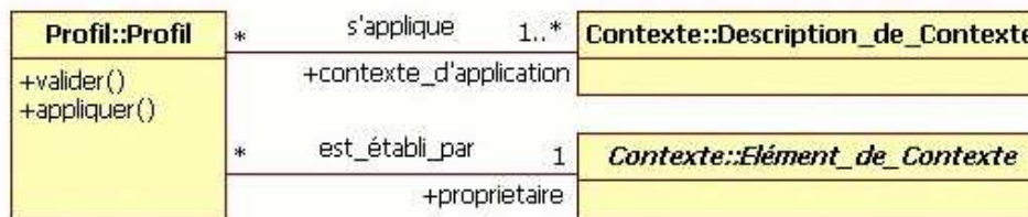
Figure 51. Un profil est établi par son propriétaire et s'applique à un contexte donné.
