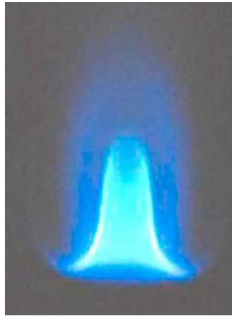
Figure 1-23: Structure d'une flamme partiellement prémélangée - configuration initiale de diffusion (Chung & Lee, 1991).
