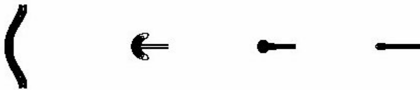
Figure 1-28: Iso-lignes du taux de réaction- Transition de la structure du front de flamme avec l'augmentation du gradient de mélange (Boulanger, 2002)
