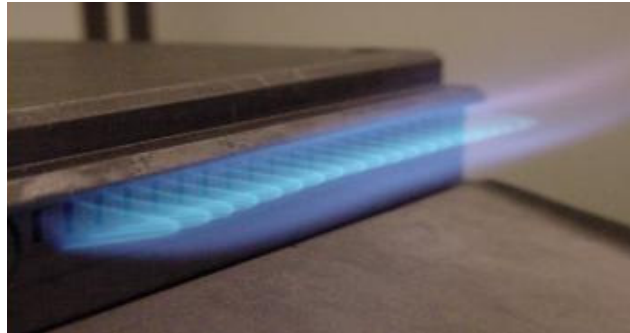
Figure 2-11 : Photographie des flammes issues du brûleur modèle bidimensionnel.
