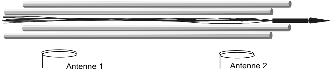
FIG. 2.5 – Expérience à deux antennes placées le long du guide pour étudier la thermalisation.
