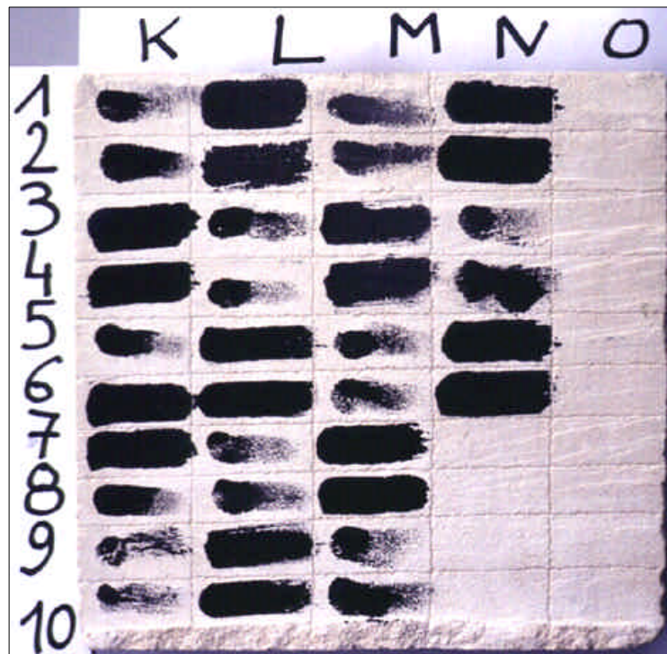
Photographie de la plaque peinte avec du minerai noir mélangé à différentes charges (quartz, talc, feldspaths potassiques). (D. Bagaud, C2RMF)
