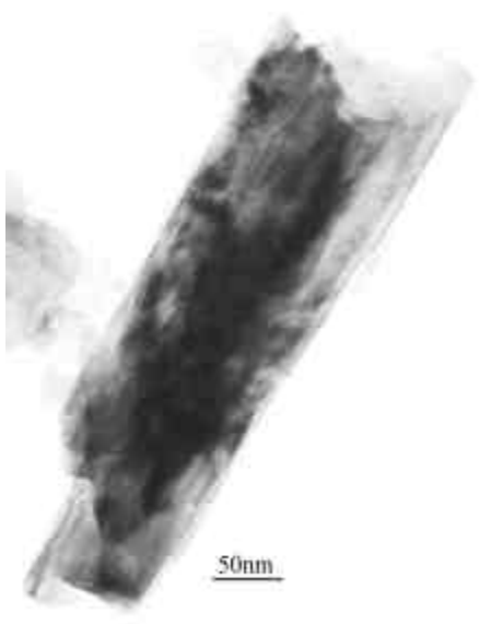
a) Monocrystal initial de manganite naturelle
