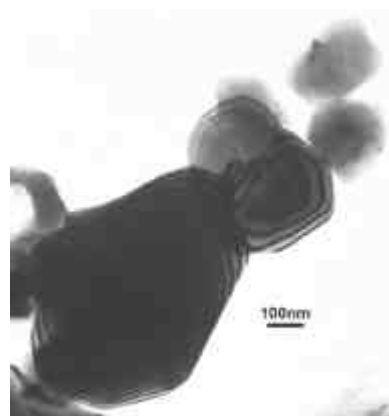
f) Hausmannite \alpha . Cristal totalement recristallisé (18h à 960°C)
