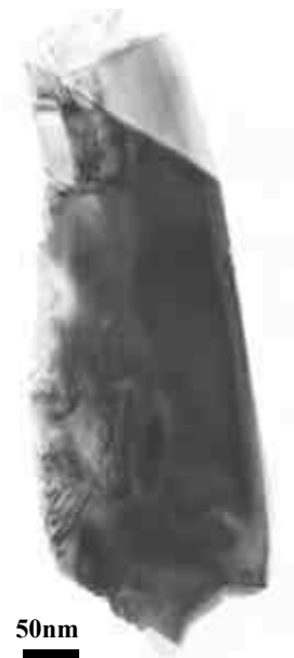
g) Cristal d'hausmannite \beta n'ayant subi aucune modification morphologique (18h à 1100°C)
