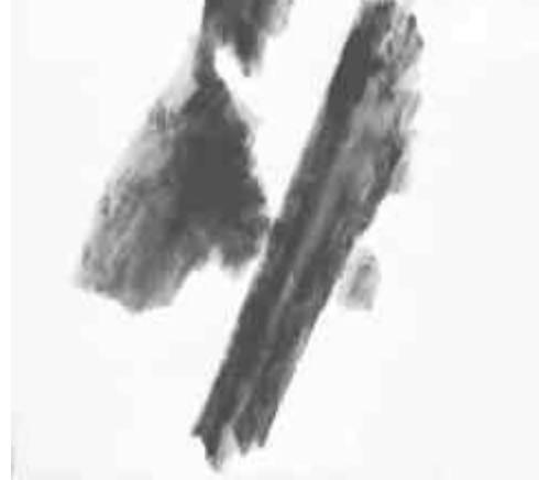
b) Cristaux de pyrolusite obtenus après traitement thermique : 18h à 450°C
