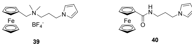
Figure I-37 : Monomères permettant de préparer par électropolymérisation des films de polymères pour la détection électrochimique des anions \text{H}_2\text{PO}_4^- , \text{HSO}_4^- ou \text{ATP}^{2-} [69, 72, 111, 112].
