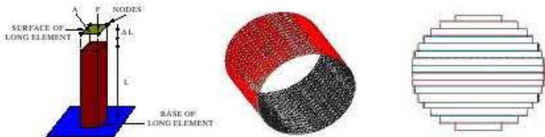
FIG. 2.5: Méthode des éléments longs : (a) description d'un élément (b) description d'un cylindre avec des éléments longs (c) description de la surface d'un cylindre.
