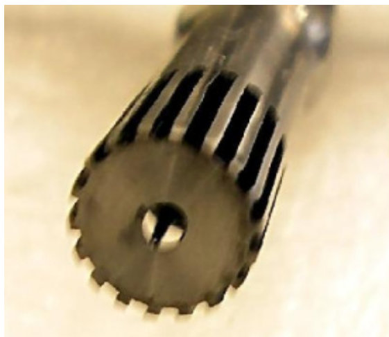
FIG. VI.4: structure de la grille d'anode
