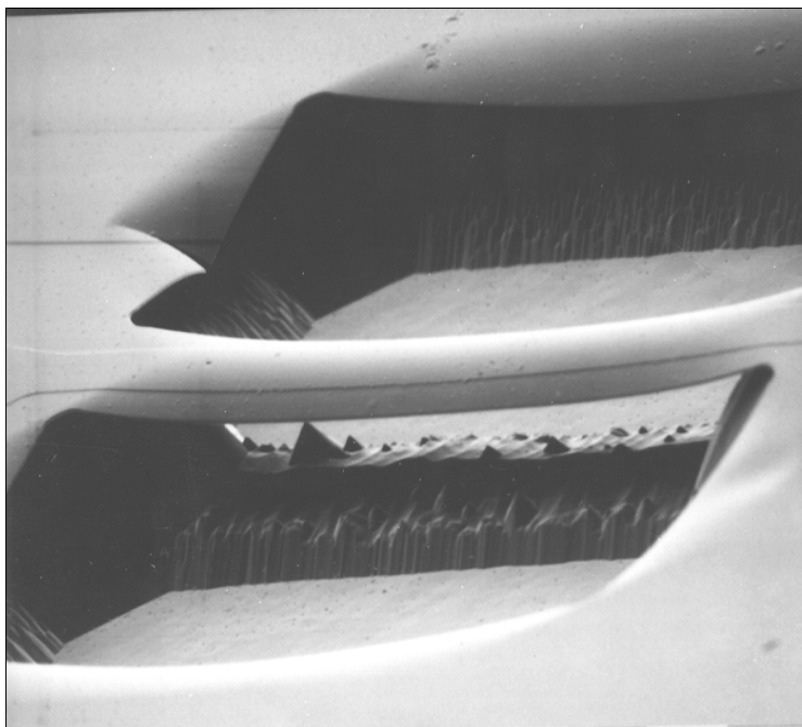
figure 2-36: Photographie MEB d'un pont fabriqué par gravure KOH. On distingue la ligne d'YBaCuO en relief.
