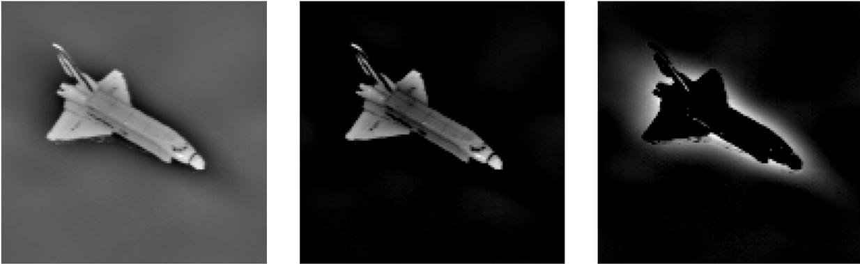
Figure 8.5 : Exemple de sélection des parties positives et négatives d'un filtre bipolaire. (a) – Filtre (bipolaire) à compromis optimal contraint au segment  $[-1, 1]$ . (b) – Partie positive. (c) – Partie négative.
