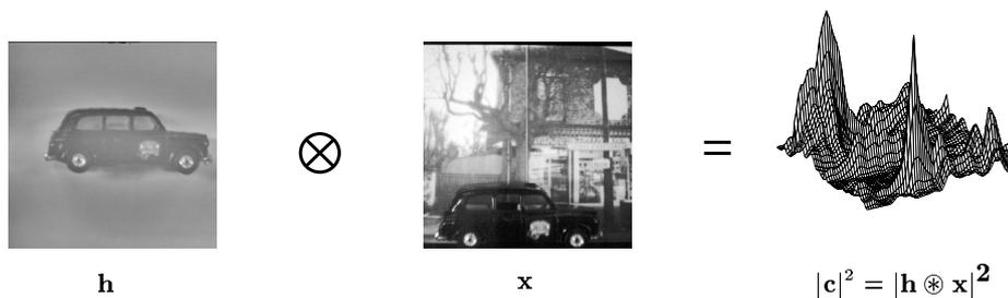
Figure 1.2 : Corrélation d'une scène  $\mathbf{x}$  avec un filtre  $\mathbf{h}$ .
