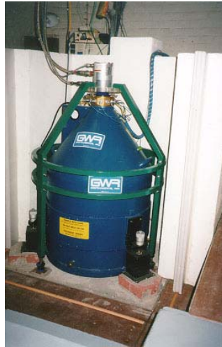
Figure 2 Gravimètre supraconducteur C026 en opération à Strasbourg depuis juillet 1996. Cet instrument remplace l'ancien modèle T005 qui a fonctionné en continu de 1987 à 1996.
