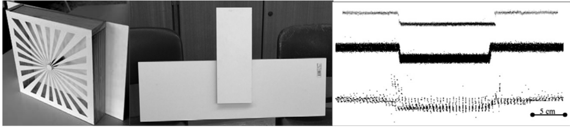
Figure 2-22 : exemple de tests de qualité utilisé par i3mainz : à droite la cible avec des fentes de largeurs variantes pour les tests de résolution, au milieu, la planche support de tests aux extrémités, à gauche un exemple de résultats aux test de qualités aux extrémités. D'après [i3M05].
