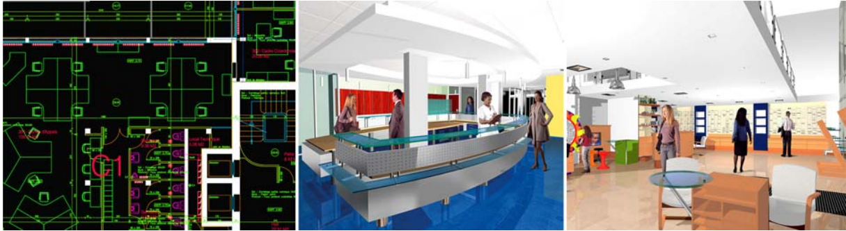
Figure 5-5 : Exemples de détails de bâtiments réalisés récemment en Lorraine : projection 2D sous AutoCAD et représentations à destination des maîtres d'ouvrage en image de synthèse réalisée à partir du logiciel 3DS Max d'Autodesk.
