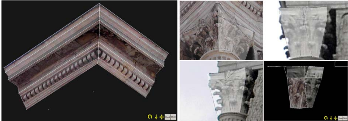
Figure 4-37 : Restitution de détails architecturaux : la corniche et un chapiteau corinthien du château d'eau du Peyrou – restitution réalisée sous Photomodeler 5 Pro.
