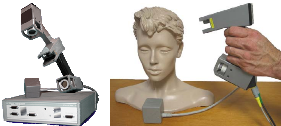
Figure 2-15 : Un scanner laser à repérage électromagnétique : le Fastscan de Polhemus [Pol06].
