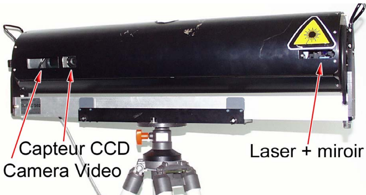
Figure 2-9 : le capteur « SOISIC » de MENSİ.
