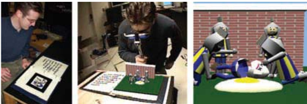
Figure 10 : les 3 modes d'utilisation du MagicBook : (a) réalité ; (b) Réalité Augmentée ; (c) immersion en Réalité Virtuelle (d'après [Billinghamurst 2001b])
