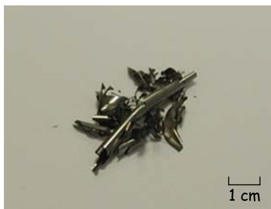
Figure 2-11 : Pyrocarbone récupéré lors d'une opération de décokage.
